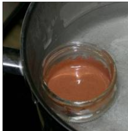
ill. n° 19 : microballons de résine phénolique mélangés avec de la colle de peau.
