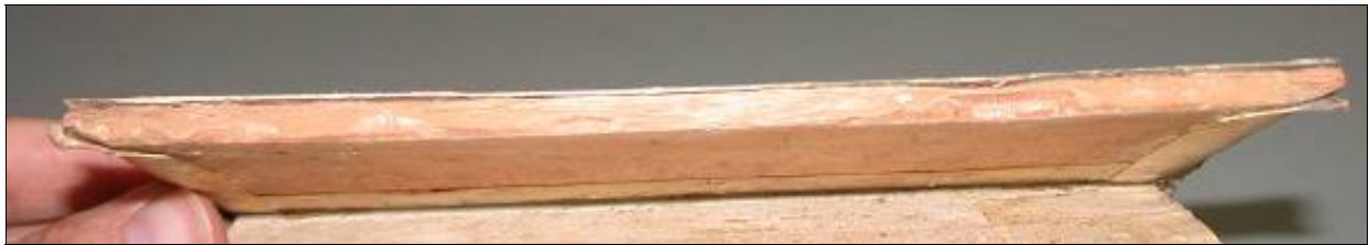
ill. n° 21 : coupe de l'ais dégradé après élimination et arasement des surplus de pâte à l'aide d'un scalpel puis par abrasion.
