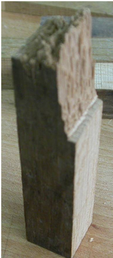
ill. n° 35 : à gauche, morceau de bois cassé à droite, en cours de comblement à l'aide de baguettes de bois collées avec de la colle de poisson. ci dessous : après traitement
