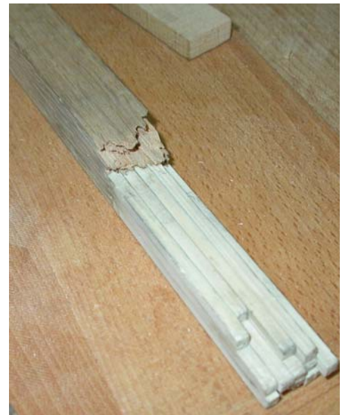
ill. n° 35 : à gauche, morceau de bois cassé à droite, en cours de comblement à l'aide de baguettes de bois collées avec de la colle de poisson. ci dessous : après traitement
