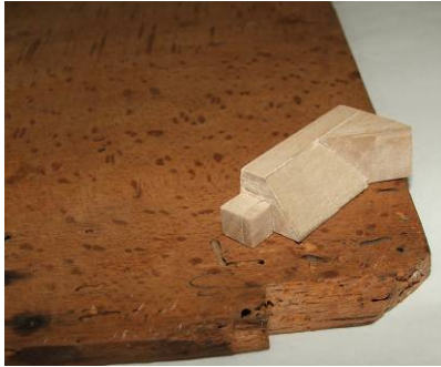
ill. n° 34 : différentes vues du coin d'un ais lacunaire après élimination partielle du bois d'œuvre pour obtenir des surfaces planes. Préparation du coin de bois d'apport puis collage
