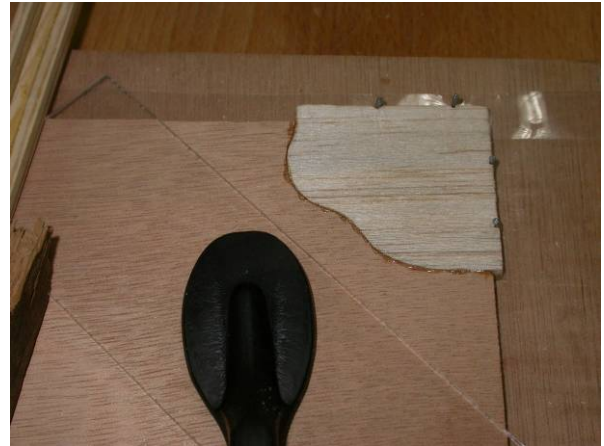
ill. n° 31 : mode de collage avec de la colle de poisson, l'ais est maintenu à l'aide de serre joint et la pièce de bois d'apport est maintenue avec des petits clous.
