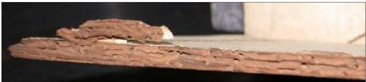
ill. n° 17 : détail, coupe de l'ais dégradé après infiltration d'une première solution de Paraloïd B72 @ à 4g/l puis d'une seconde à une dilution de 15 g/l.
