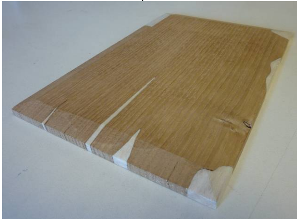
ill. n° 29 : différents exercices de comblement de lacune sur une planche de châtaignier avec du balsa. Les collages ont été effectués avec de la colle de poisson.
