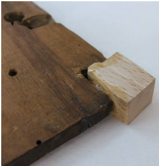
ill. n° 32 : découpe du bois d'apport pour le coin d'un ais
